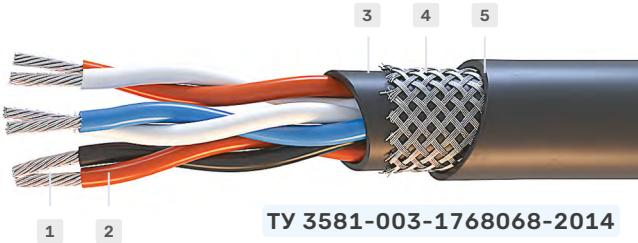
**КОНСТРУКЦИЯ**1. **Токопроводящая жила** медная лужёная многопроволочная2. **Изоляция** соответствует материалу оболочки**Скрутка** парная ( $N \times 2 \times S$ , где N – количество жил, 2 – жилы скрученны попарно, S – сечение жил)3. **Внутренняя оболочка** соответствует материалу оболочки.4. **Броня** в виде оплетки стальными оцинкованными проволоками5. **Оболочка:**
