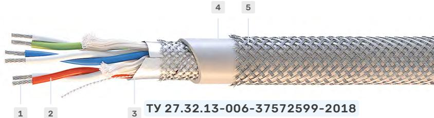
**КОНСТРУКЦИЯ**1. **Токопроводящая жила** медная луженая многопроволочная диаметром 0,6 мм.2. **Изоляция** сплошной полиэтилен.
